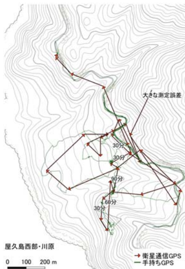
図4 2023年9月に、著者が衛星回線を用いて位置を送った例。△は衛星回線で送った位置。緑色は手持ちのGPSの軌跡。○○分は送信するまでにかかった時間。本来は10分間隔で送信するが、衛星と通信できないと時間がかかる。
