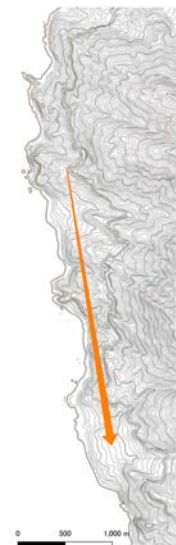
図5 簡易デジタル無線機で経験的に通じる場所の例。障害物が無ければ、3km程度の距離でも通話できる。
